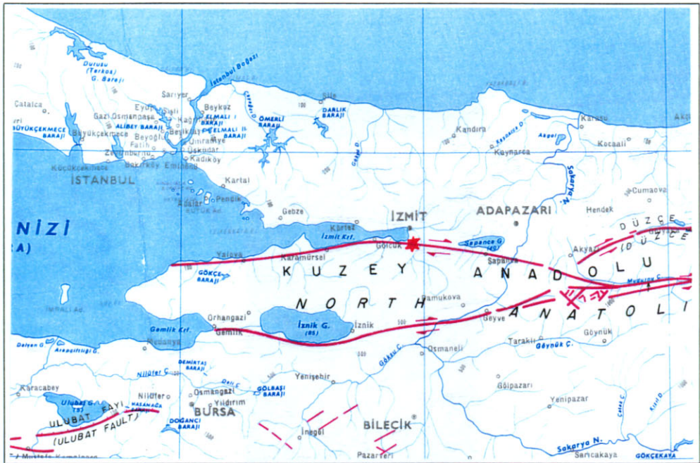
Εικ. 1 Γεωγραφικός χάρτης με τμήματα της Ν.Α.Φ.Ζ. στην ευρύτερη περιοχή Κωνσταντινούπολης, Ιζμίτ και Υαλόνα. Με τον αστερίσκο σημειώνεται η θέση του επικέντρου, ενώ διακρίνεται η δεξιόστροφη οριζόντια μετάθεση των εκατέρωθεν τεμαχών.
