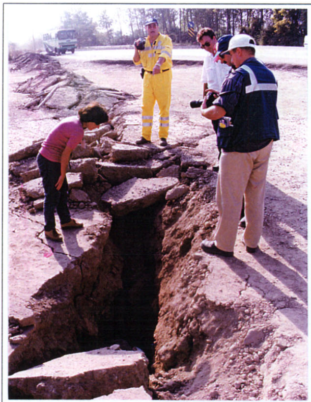
Εικ. 3 Εμφάνιση του σεισμικού ρήγματος με γενική διεύθυνση Α-Δ, στα ανατολικά προάστια της πόλης Gölcük.
